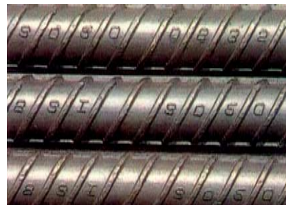
(ข) ลักษณะของเหล็กข้ออ้อย
