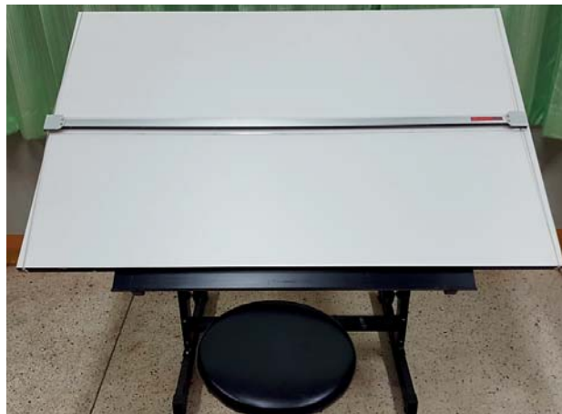
รูปที่ 1.8 แสดงไม้ทิสไลด์ที่ยึดติดกับโต๊ะเขียนแบบ
