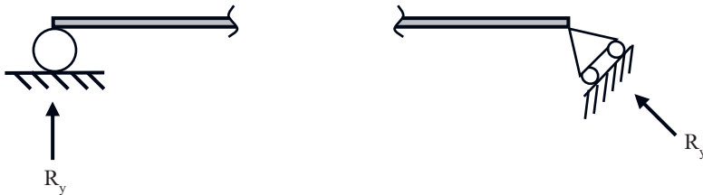
รูปที่ 1.6 สัญลักษณ์ของฐานรองรับแบบยึดหมุนเคลื่อนที่ได้ (Roller Support)
