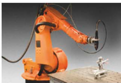
รูปที่ 1.13 หุ่นยนต์ที่ปลายสุดเป็นกริปเปอร์หยิบจับตัวยูเอชบี
