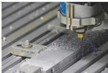
รูปที่ 1.6 เครื่อง CNC ที่ทำงานแบบ Cartesian Coordinate
