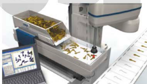
รูปที่ 1.9 หุ่นยนต์ KUKA ที่มีแกนขนานกัน 2 แกนควบคุมด้วย PLC
