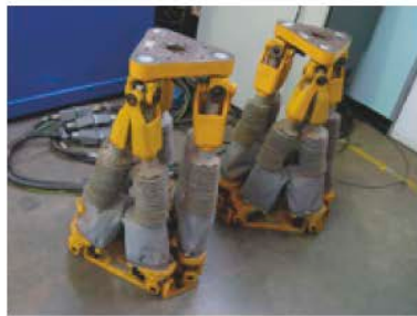
รูปที่ 1.12 หุ่นยนต์แบบคู่ขนาน ใช้ระบบนิวแมติกส์เป็นตัวขับเคลื่อน
