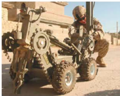
รูปที่ 1.4 หุ่นยนต์ตรวจหาและทำลายกับระเบิดของกองทัพอากาศสหรัฐฯ
