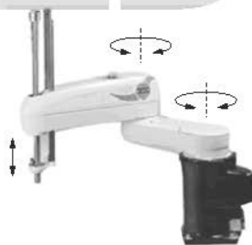
รูปที่ 1.9 หุ่นยนต์ KUKA ที่มีแกนขนานกัน 2 แกนควบคุมด้วย PLC
