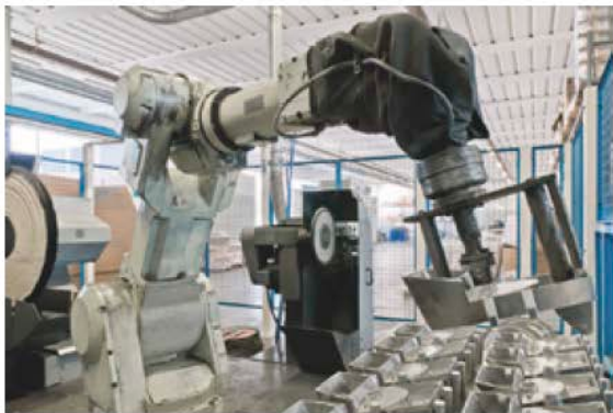
รูปที่ 1.10 หุ่นยนต์หยิบจับชิ้นงานหล่อในโรงงานหล่อโลหะ
