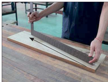
รูปที่ 2.22 แสดงการใช้ฉากจันทันตรวจสอบความเรียบของผิวไม้
