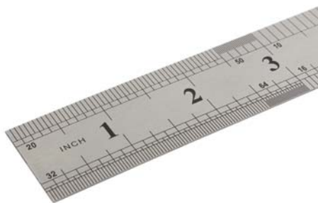
รูปที่ 1.1 บรรทัดเหล็กมาตรฐานวัดระบบอังกฤษ สเกลด้านบน 1 นิ้ว จะแบ่งออกเป็น 10 ซิด และสเกลด้านล่าง 1 นิ้ว จะแบ่งออกเป็น 8 ซิด
