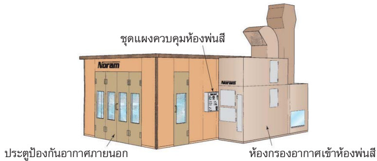
รูปที่ 1.15 การติดตั้งอุปกรณ์ถ่ายเทอากาศ
