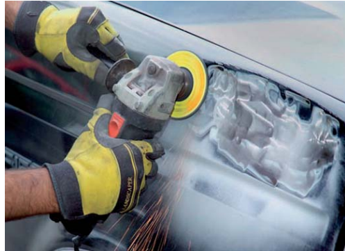
รูปที่ 2.10 การใช้เครื่องขัดแบบชิงเกลแอ็กชั่นในการลอกสีเดิมออกจากตัวถังรถ
